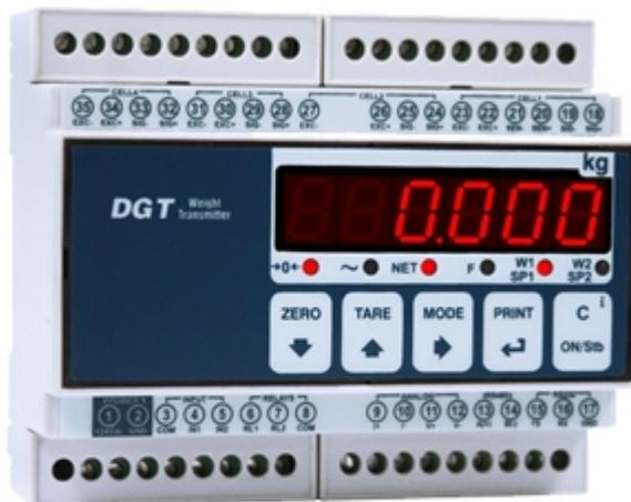
Multifunktionaler Wäge-Indikator zur Hutschienen-Montage. Ideal als "digitaler" Anschlusskasten für 4 unabhängige od. abhängige Kanäle. Direkte Abfrage und Diagnose jeder angeschlossenen Wägezelle möglich. Die verfügbaren Schnittstellen ermöglichen die einfache und sichere Integration eines Wägesystems in jedes Automatisierungssystem. CE-M eichfähig (OIML R-76 / EN 45501).
