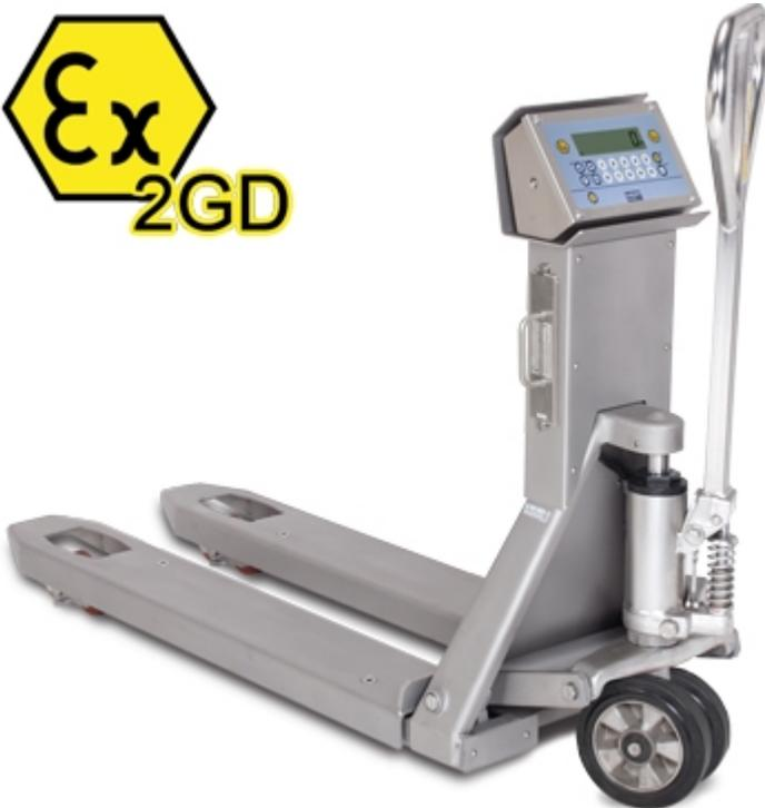
Gabelhubwagen mit Waagenfunktion, geeignet für den Einsatz in explosionsgefährdeten Bereichen (ZONEN 1 und 21 & 2 und 22), ATEX-Kennzeichnung Ex II 2GD IIB T4 T197°C X. Die Lastaufnahme über 4 ATEX-zertifizierte Wägezellen (Edelstahl, IP68) garantiert optimale Wägeregebnisse in allen Betriebsarten. Hubwagen ist komplett in Edelstahl. Verfügbar auch in eichfähiger Version (CE-M).
