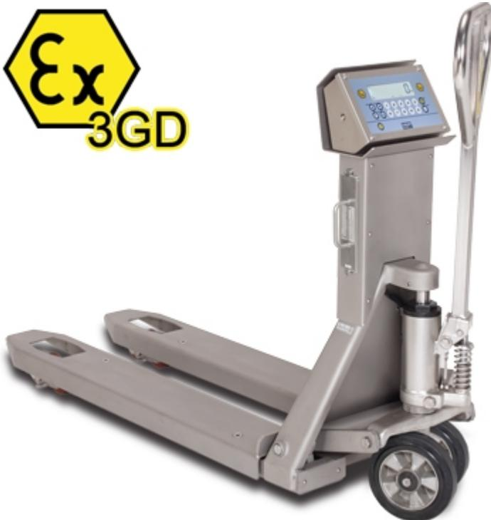
Gabelhubwagen mit Waagenfunktion, geeignet für den Einsatz in explosionsgefährdeten Bereichen (ZONEN 2 und 22), ATEX-Kennzeichnung Ex II 3GD IIC T6 T130°C X. Die Lastaufnahme über 4 ATEX-zertifizierte Wägezellen (Edelstahl, IP68) garantiert optimale Wägeregebnisse in allen Betriebsarten. Hubwagen ist komplett in Edelstahl. Verfügbar auch in eichfähiger Version (CE-M).
