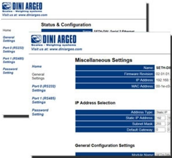
Die Programmierung ist leicht zugänglich über integriertes Web-Interface.
