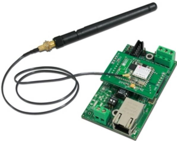
Geringe Abmessungen, sehr gute Signalqualität, Neigungseinstellung und Ausrichtbarkeit der Antenne sind nur einige der Eigenschaften dieses Produktes für den einfachen drahtlosen Anschluss jeder Waage oder Wägesystems an das Firmen-Computer-Netzwerk. Einfache Montage und Anschluss an den Wäge-Indikator über mitgeliefertes Kabel. Das Modul kann gemeinsam mit anderen DINI ARGEO-Produkten eingesetzt werden wie z.B. Kontroll-Leuchte, Alibispeicher und Drucker (angeflanscht oder extern).
