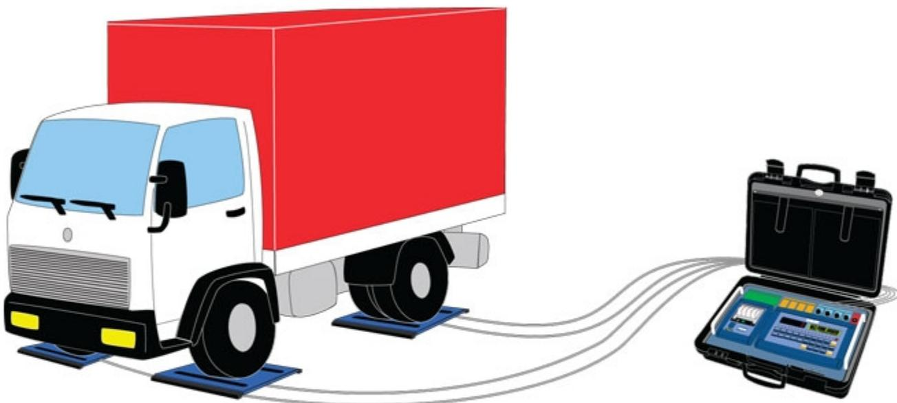
Geeignet zum Aufbau von Fahrzeug-Wägesystemen, statischen Achslast-Wägesystemen, zum Wiegen von Objekten mit mehreren Auflagepunkten. Besonders geeignet zur Wägung mit Schwerpunkt-Berechnung (Koordinaten) von Fahrzeugen, Lastwagen, Flugzeugen, Containern etc. Zeitgleiche Visualisierung des Gewichts jeder
