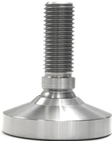
Edelstahl-Gelenkfuß, konstruiert für präzise Gewichtsmessungen, besonders geeignet zum Aufbau von Waagen mit 4 Wägezellen. Extrem kompakt und einfach zu installieren. Die Höhe der Plattform wird minimiert. Der Gelenkfuß liefert eine perfekte Entkopplung von Seitenkräften während des Wiegevorganges.
