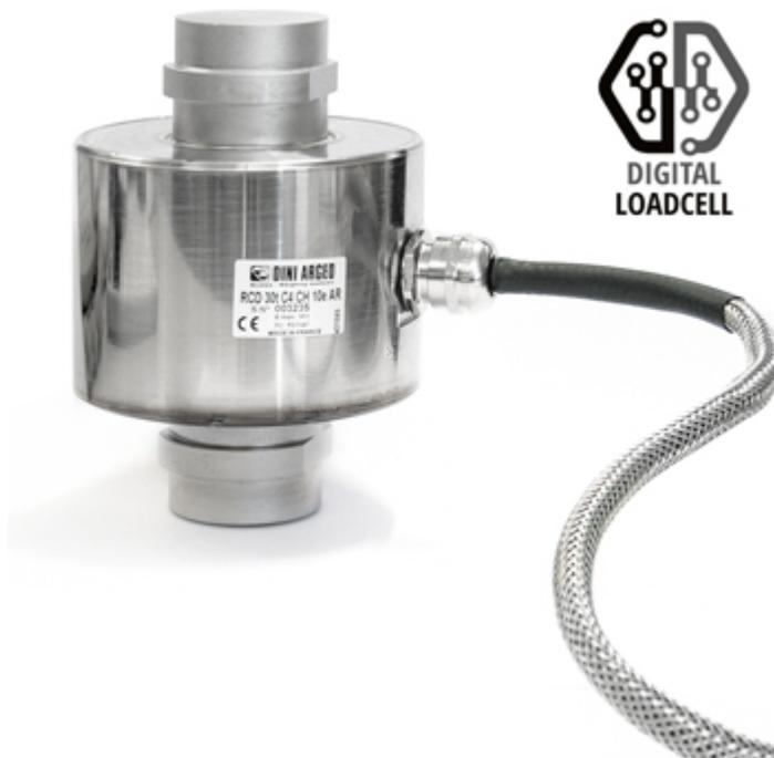
Druckkraft-Wägezelle, DIGITALE Version, für eichfähige Waagen (CE-M), geeignet für Wägebrücken, Tanks, Silos, etc., serienmäßig abgeschirmtes Anschlusskabel „Anti-Ratten“, Ausgang RS485.
