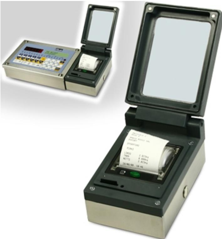
Thermo-Drucker im Edelstahl-Gehäuse mit Schutzhaube gegen Feuchtigkeit und Schmutz, Schutzart IP 65. Besonders geeignet für den Einsatz in der Chemie-, Lebensmittelindustrie und bei besonderen hygienischen Anforderungen. Montierbar an Wäge-Indikatoren "XT" mit Edelstahl-Gehäuse.
