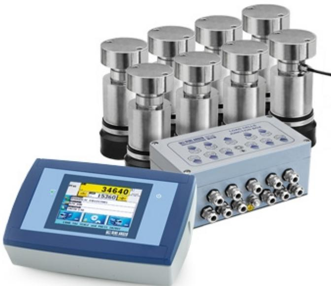
Bausatz für die Realisierung von analogen Brückenwaagen, bestehend aus Gewichtsanzeige 3590ET mit Touchscreen mit AF03 Programm spezifisch für Wägebrücken, 8 analoge Wägezellen der Serie DINI AR GEO "RCPT", IP68, komplett mit Schwinggelenken aus verzinktem Stahl und analogem Ausgleichskasten, mit Überspannungsableiter.
