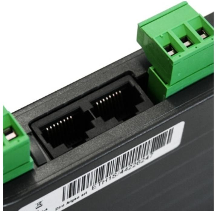
Dank des Quick-Connect-Systems ist die Verbindung zwischen Wäge-Indikator DGT1S und EtherCAT einfach und schnell zu realisieren.
