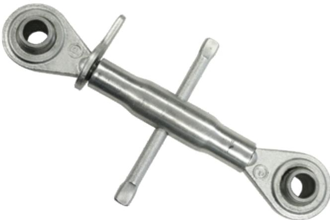
Galvanisierter Querlenker, nützlich um Bewegung der Wägek­onstruktion zu begrenzen ohne das Wiegeergebnis zu beeinflussen. Ausgestattet mit zwei Gelenkköpfen (Gesamtlänge einstellbar von 260 bis 350 mm).
