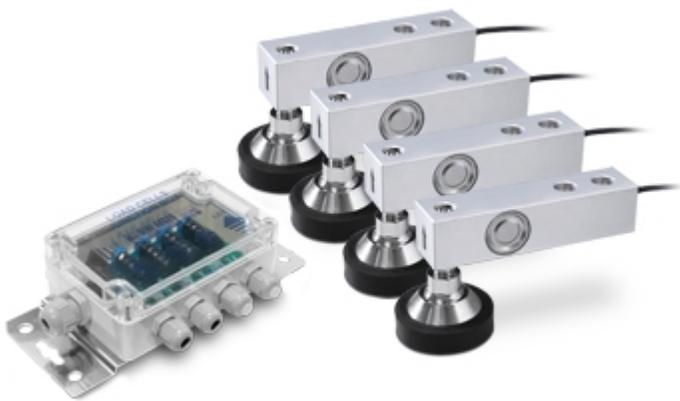
Ideal zum Bau einer eichfähigen Wäge-Plattform (CE-M) mit 4 Wägezellen in verschiedenen Größen und Nennlasten. Ein Kit besteht aus 4 Aluminium-Wägezellen, Schutzart IP67, 4 höhenverstellbaren Vernickeltem Stahl-Füßen und einem Anschlusskasten.
