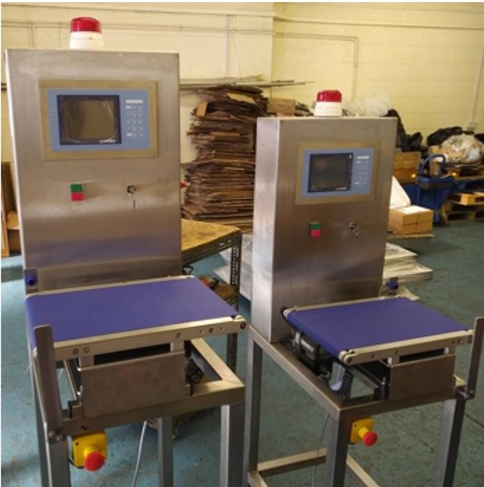
Beispiele für Installationen von Bandwaagen zur Gewichtskontrolle
