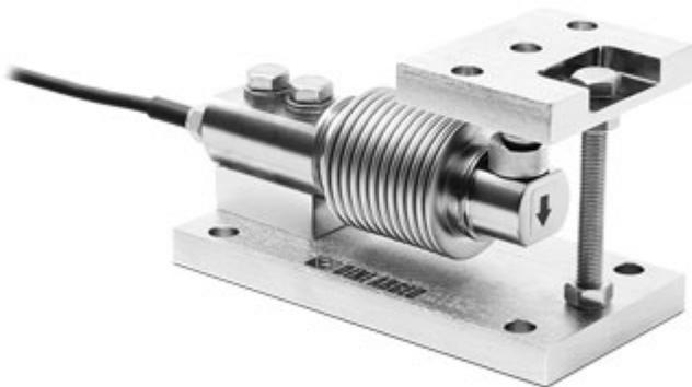
Bausatz für Biegestab-Wägezellen der Serie FXC/FXD bis 500 kg, mit einfachem Überrollschutzsystem und Seitenkräfte-Ausgleich.
