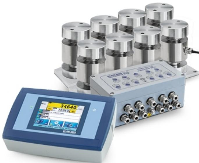
Bausatz für Wägebriicken, bestehend aus dem Wäge-Indikator 3590ETD mit Firmware AF03 (für Erst- und Zweitwägung), 6 bzw. 8 digitale "RCD" Wägezellen aus Edelstahl, Schutzart IP68, komplett mit Pendellager aus verzinktem Stahl und Anschlusskasten mit integriertem Überspannungsschutz.
