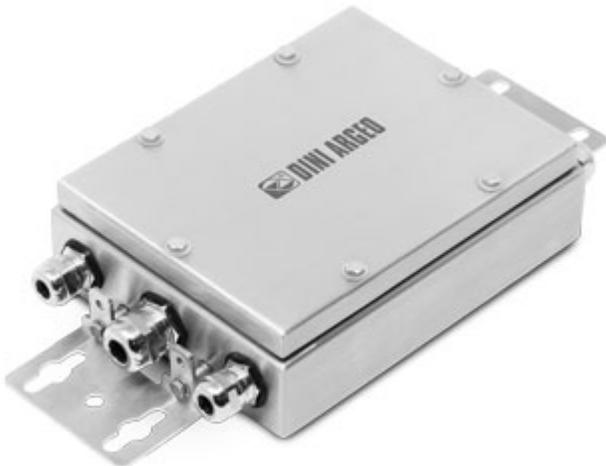
Anschlusskasten aus AISI 304 Edelstahl mit Schutzgrad IP68/IP69K gegen Wasser und Staub, ausgestattet mit einer elektronischen Karte zur Verbindung und zum Abgleich von 4 Zellen. Trimmer zur Signalanpassung, für einen präzisen und zuverlässigen Abgleich. Die reversible Befestigungshalterung ermöglicht es, den Anschlusskasten platzsparend an die Wand zu hängen.
