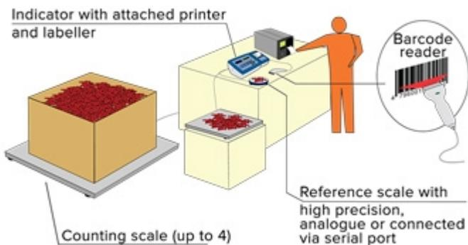
Geeignet für anspruchsvolle Applikationen in der Stückzählung, mit Daten- und Druck-Verwaltung. Interne Zähl-Auflösung bis zu 1.500.000 Teile. Bis zu 5 unabhängige Waagen anschließbar. CE-M eichfähig (OIML R-76 / EN 45501).
