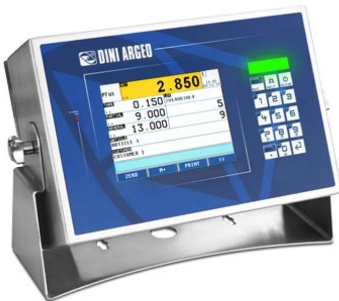
Erweiterte Gewichtsanzeige, Edelstahl AISI304 mit resistivem Touchscreen-Display, geeignet für jede industrielle Anwendung. Es können alle Wägedaten angezeigt werden, und mit Anpassung des Bildschirm-Layouts wird die Benutzerbedienung vereinfacht. Ausgestattet mit 3 seriellen Schnittstellen, Übertragungsprotokollen für Datenkommunikation, komplett konfigurierbare Ausdrücke, integrierter Alibispeicher und Schnittstelle zum Anschluss an Barcode- / Badgeleser. CE-M eichfähig (OIML R-76 / EN 45501).
