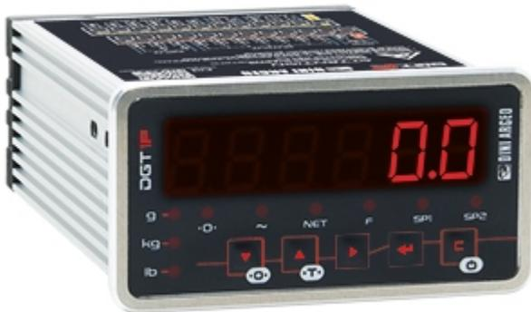
Transmitter / Gewichtsanzeige für Schalttafeleinbau mit Aluminiumgehäuse. Ideal als Mikrocontroller in industriellen Wäge- und Dosiersystemen und macht es einfacher und sicherer, das Wiegen in jedes Automatisierungssystem zu integrieren. Bis zu 2 programmierbare digitale Eingänge und 6 programmierbare Ausgänge.
