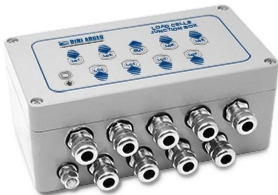
Anschlusskasten mit Elektronikplatine zum Anschluss und Abgleich von bis zu 8 Wägezellen. Besonders geeignet für Fahrzeugwaagen dank der integrierten Überspannungsableiter. Geeignet für raue Umgebungsbedingungen, mit metallischen Kabelverschraubungen und Erdung. Schraubklemmen zum einfachen Anschluss der Wägezellen und Abgleichwiderstände für einen genauen und zuverlässigen Eckenabgleich.
