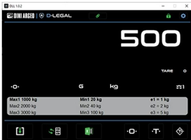
DLEGAL ist eine zugelassene digitale Waage, d.h. eine Software, durch die der PC zum primären Gewichtsanzeiger des Wiegesystems (NAWI) wird.
